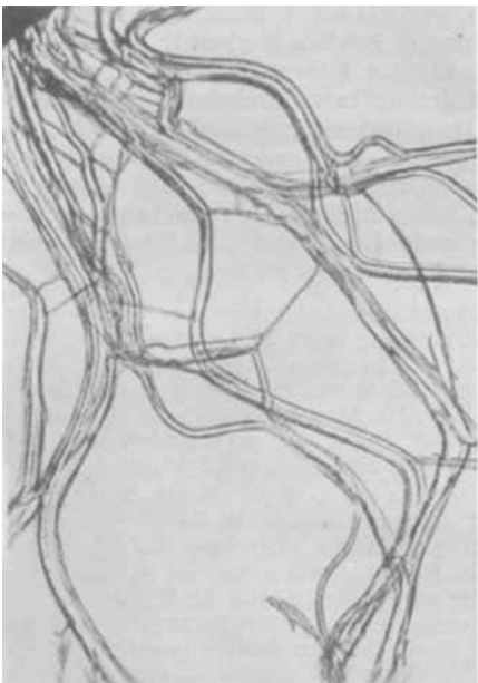
Abb. 10. Viscosekunstseide, Teil aus Abb. 9. Vergr. 375fach.
