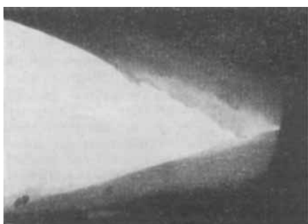
Abb. 38. Viscosezellwolle, gequollen und gepreßt. Vergr. 12000fach.
