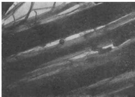
Abb. 29. Ramiefaser, gequollen und gepreßt. Vergr. 10500fach.
