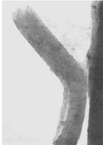
Abb. 23. Baumwoll-Fibrille, Teil aus Abb. 22 Vergr. 72000fach, Original 18000fach).
