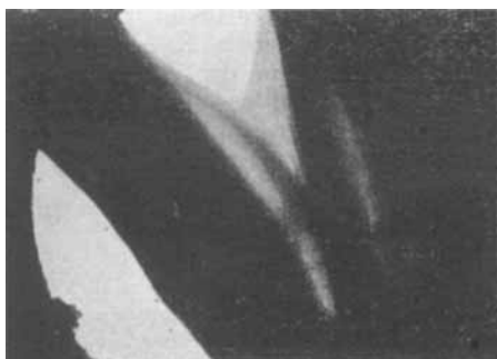
Abb. 35. Viskosekunstseide, gequollen und gepreßt. Vergr. 7000fach.
