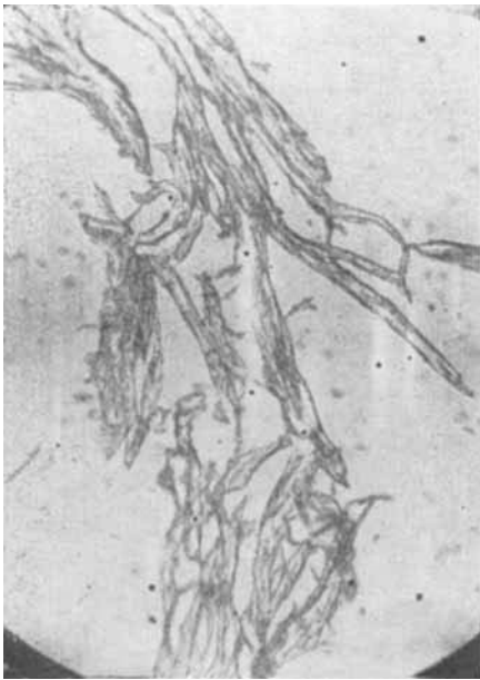
Abb. 16. Formaldehyd-Essigsäure-behandelte Spezial-Viscosezellwolle, gequollen und gepreßt. Vergr. 375fach.
