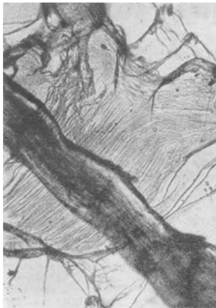
Abb. 4. Ramiefaser, gequollen und gepreßt. Abgelöste Wandschicht. Vergr. 375fach.
