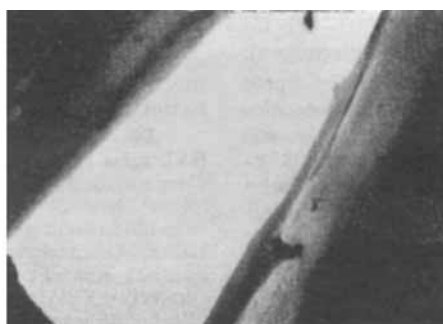
Abb. 39. Hochpolymere Viscosezellwolle, gequollen und gepreßt. Vergr. 9200fach.
